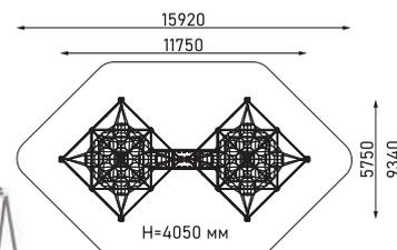
Пространственная канатная конструкция с полусферами
