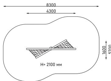
Пространственная канатная конструкция
