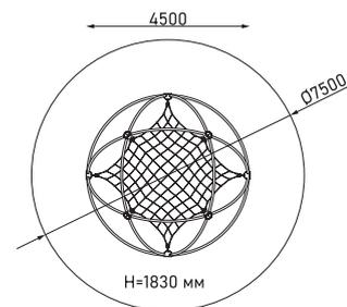
Пространственная канатная конструкция с полусферами
