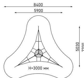
Пространственная канатная конструкция
