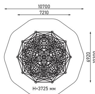
Пространственная канатная конструкция с полусферами
