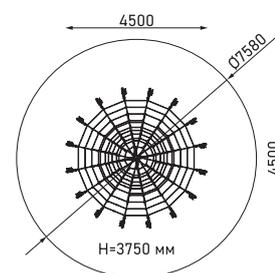
Пространственная канатная конструкция
