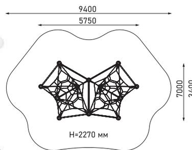
Пространственная канатная конструкция с полусферами
