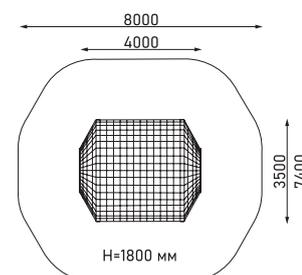
Пространственная канатная конструкция
