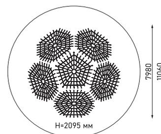
Пространственная канатная конструкция с полусферами
