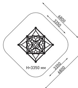
Пространственная канатная конструкция с полусферами
