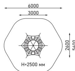
Пространственная канатная конструкция
