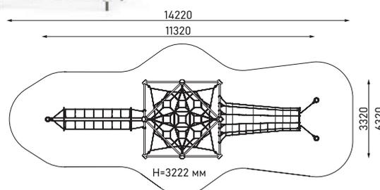
Пространственная канатная конструкция с полусферами
