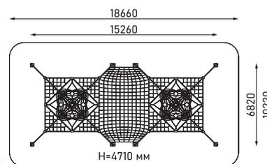
Пространственная канатная конструкция с полусферами
