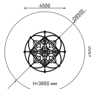
Пространственная канатная конструкция с полусферами
