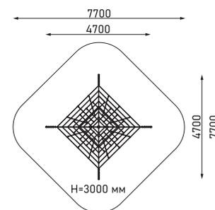
Пространственная канатная конструкция
