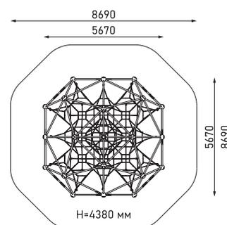
Пространственная канатная конструкция с полусферами
