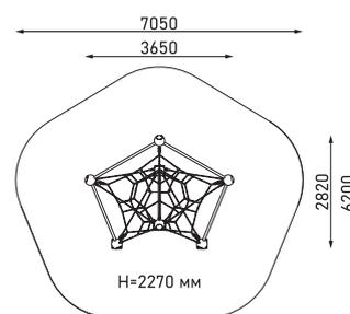
Пространственная канатная конструкция с полусферами
