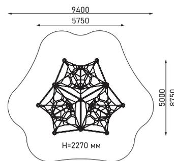
Пространственная канатная конструкция с полусферами
