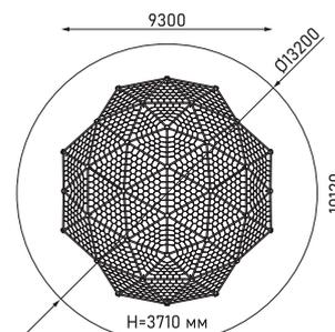
Пространственная канатная конструкция с полусферами
